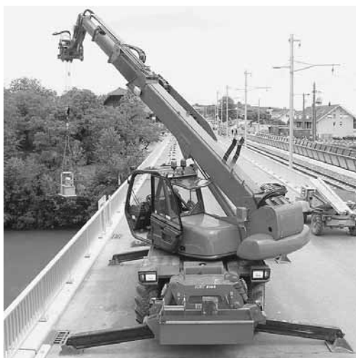
Foto 5 autogrù: sollevatore telescopico con argano
